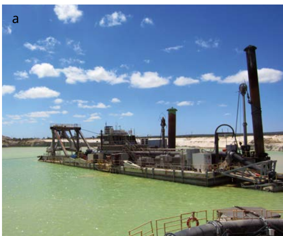
Abb. 4: Schwermineralsand-Abbau im Westen von Australien (Cooljarloo, TRONOX). Die Schwerminerale werden hier im Nassabbauverfahren gewonnen. Abbildung (a) zeigt den Saugbagger, der das Sediment abbaut. Von dort aus wird es in die schwimmende Nassaufbereitungsanlage (b) gepumpt. Fotos: BGR
